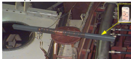
Figura 2: Modelo experimental e montagem típica da barra de prova sob o enrolamento estatórico de hidrogeradores [11].
