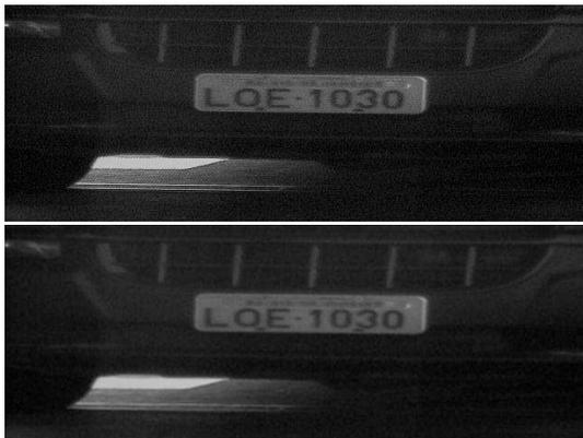
Figura 1: Imagem sem pré-processamento (superior) e após filtragem passa-baixa (inferior).
