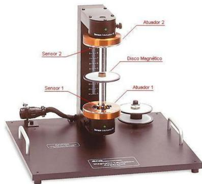
Figura 1: Foto do sistema físico de levitação magnética da ECP.
