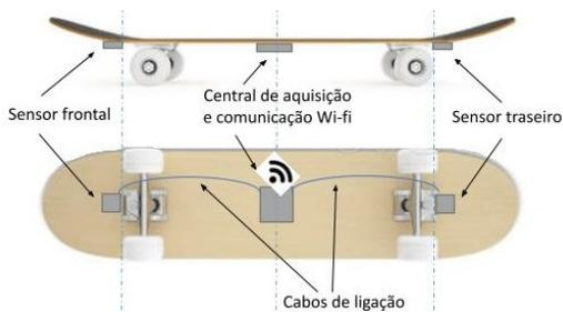
Figura 1. Esquema da instrumentação do skate, considerando a fixação dos sensores em posições simétricas próximas aos eixos em uma linha longitudinal central.
