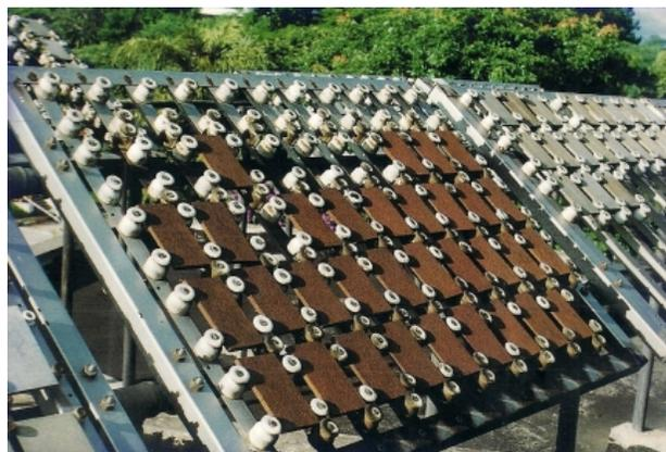
Fig. 1. Estação de Corrosão usada na pesquisa do IPT.
