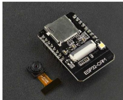
Fig. 5. Plataforma de Desenvolvimento ESP32- Cam. Fonte: [31]
