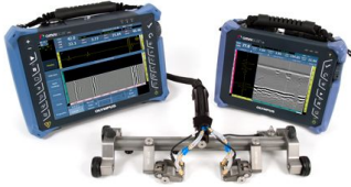
Figura 2: Equipamento que permite a aplicação da técnica TOFD (Disponível em https://www.olympus-ims.com ).
