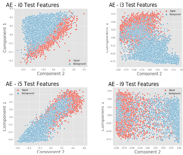
Figura 6. Projeção da informação anelada de calorimetria em duas componentes, obtidas através da rede auto-codificadora discriminativa com três camadas (50-25-2), para diferentes iterações.
