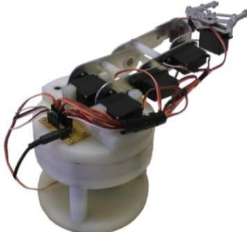
**Fig. 9.** Protótipo do manipulador robótico.
