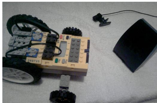
Figura 5: Protótipo do robô e sua torre infravermelho.
