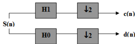
Fig. 3. Codificação em sub-bandas: H0 = filtro passa-baixa; H1 = filtro passa-alta; S(n) = entrada; c(n) e d(n) = saídas; \downarrow 2 = decimação por 2.
