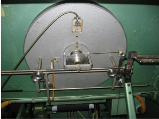
Figura 2.1 – Sistema de indicação de força.
