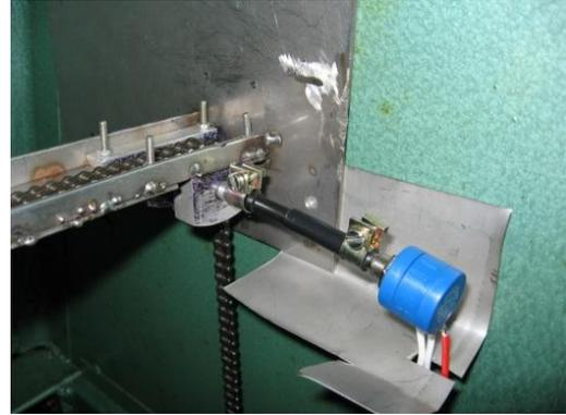
Figura 2.2 – Dispositivo de acoplamento do potenciômetro.
