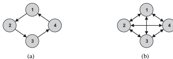
Figura 3: Esquema das Topologias de Migração entre 4 Subpopulações: (a) em anel e (b) totalmente ligada.
