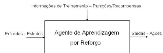
Figura 1: Diagrama esquemático de um sistema de aprendizagem por reforço.
