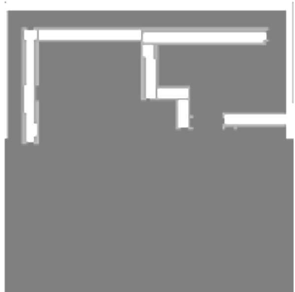
Figura 8 - Ambiente parcialmente mapeado pelo automóvel com auxílio do sistema de percepção.
