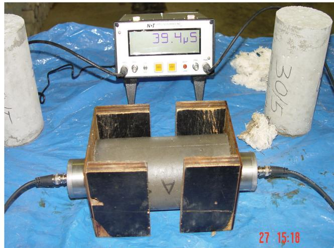
Figura 1. Ensaio de UPV em um corpo-de-prova de concreto.
