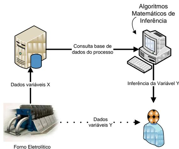
Figura 2 – Diagrama do princípio do sensor virtual.
