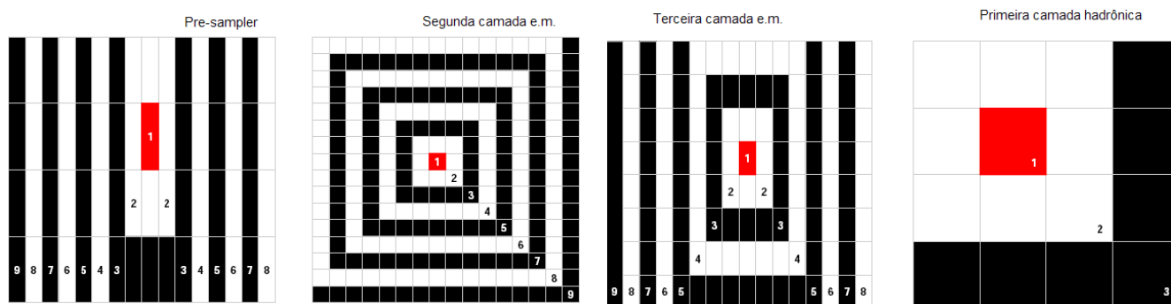
Figura 6: Exemplo da topologia dos anéis para algumas camadas dos calorímetros do ATLAS.
