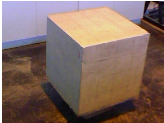
Figura 7 – Bloco de concreto com defeito para ensaios em laboratório.
